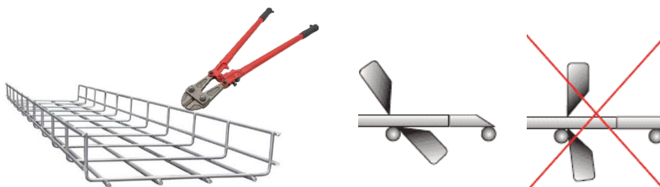
Рис.48 Правила реза проволочного лотка
